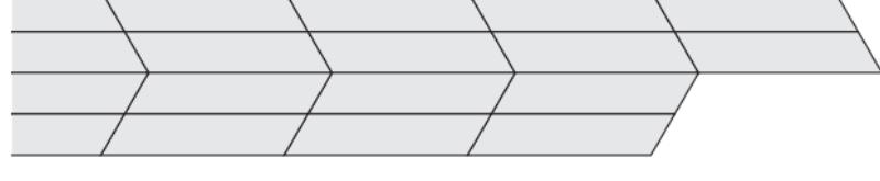
Juster på nytt etter at tre eller fire rader er lagt. Bruk avstandsklosser. Sørg for at de første radene er nøyaktige. Bruk for eksempel snor/krittsnor eller retholt. Fortsett med resten av rommet som beskrevet.
