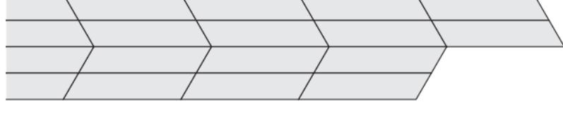
Nachdem drei bis vier Reihen zusammengesetzt sind, nochmals justieren. Verwenden Sie Klötzchen/Keile als Abstandshalter. Vergewissern Sie sich, dass die erste Reihe gerade ist. Überprüfen Sie das mittels einer Schnur, einem Richtscheit oder ähnlichem. Nun verlegen Sie den restlichen Raum auf die hier beschriebene Weise.
